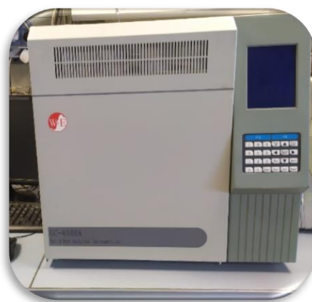
Figura 52. Cromatógrafo de gases GC 4000A utilizado para el análisis del biogás (CO 2 y CH 4 ).
