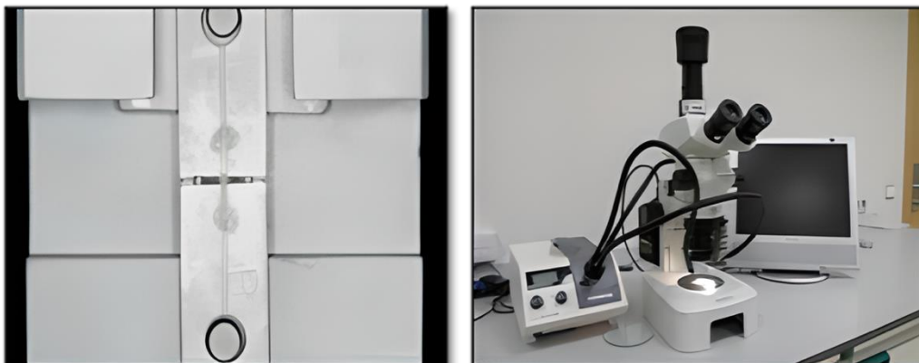
Figura 4-7. Tracción de las barras en máquina Instron y observación en el estereomicroscopio.
