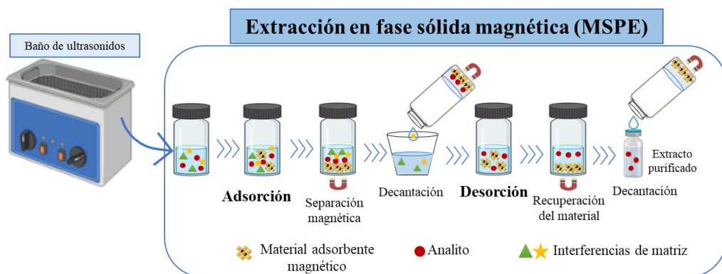
Figura 8. Esquema de las etapas del procedimiento de extracción en fase sólida magnética (MSPE).
