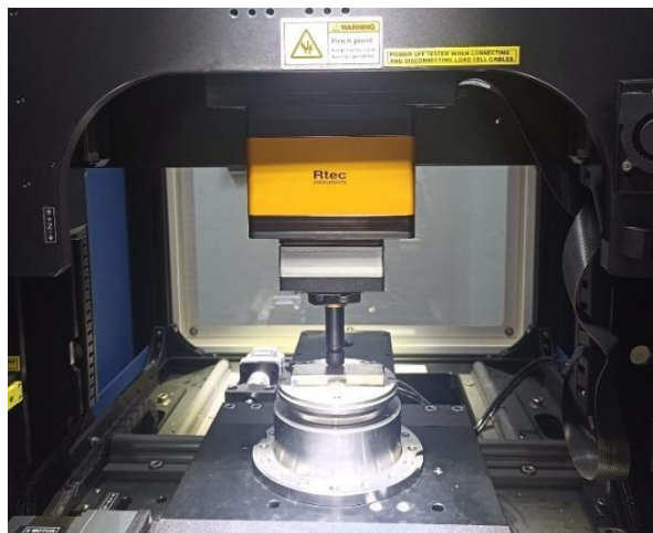
Figura 18. Tribómetro MFT-500, utilizado para realizar los ensayos de rayado.
