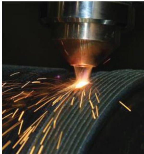
Figura 7. proceso de recubrimiento Láser-DED [27].
