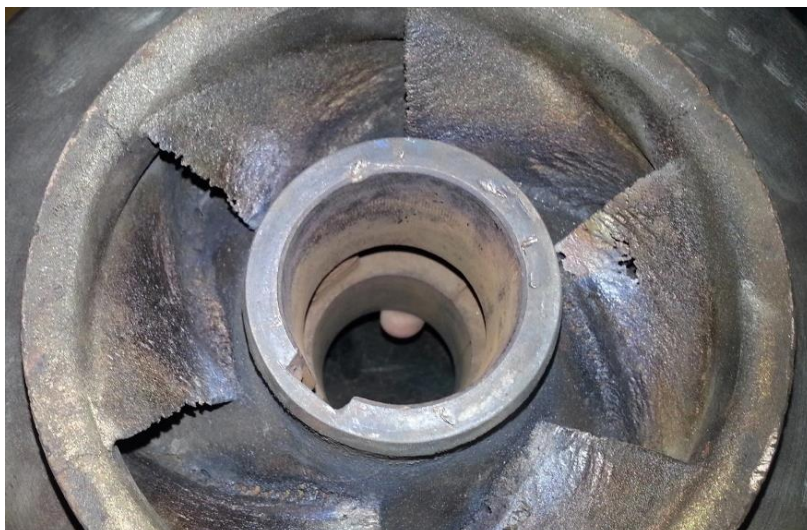
Figura 3. Álabes desgastados de una turbina [12].
