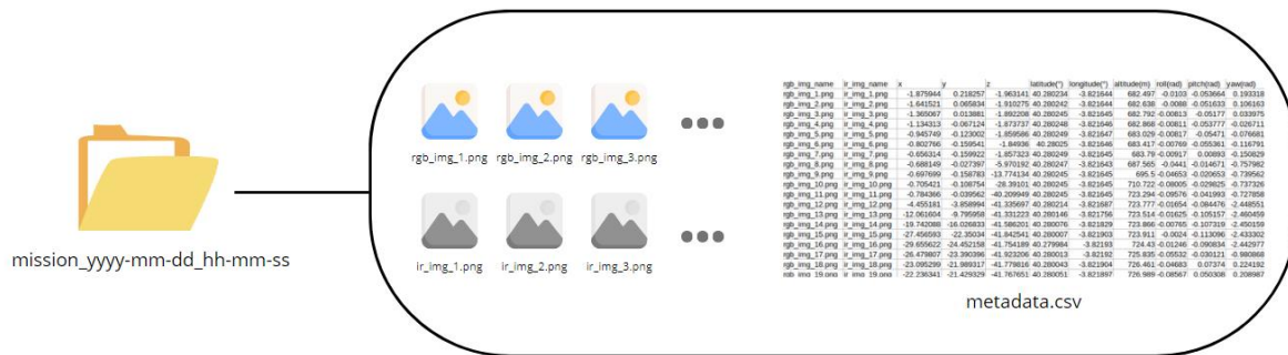
Figura 5-1: Estructura del directorio autogenerado por la misión
