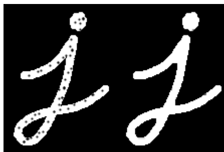
Figura 3-16: Cierre de una imagen binaria (OpenCV Docs, 2024)
