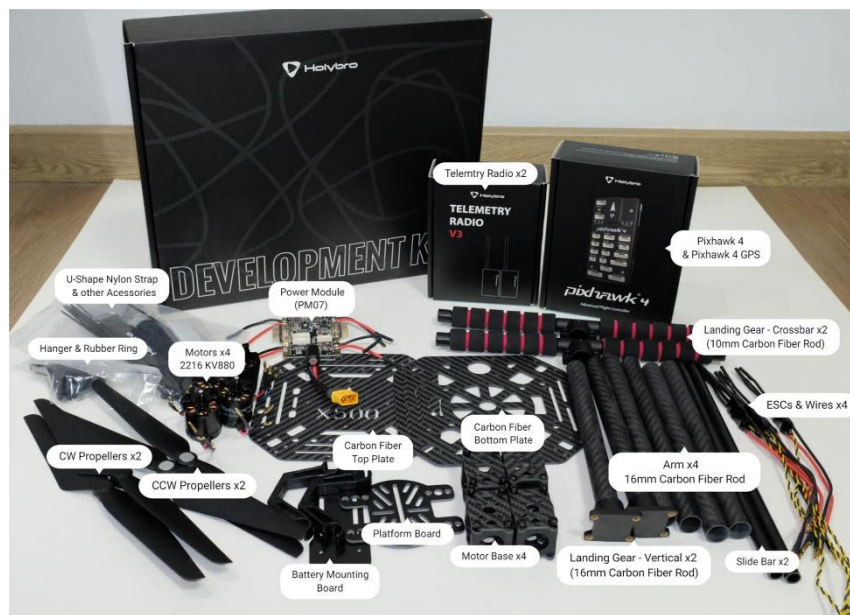
Figura 2-5: Componentes del kit Holybro X500 identificados (PX4 Autopilot, 2023)
