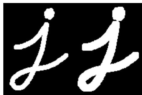
Figura 3-15: Dilatación de una imagen binaria (OpenCV Docs, 2024)
