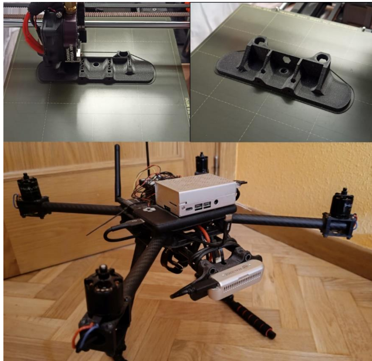
Figura 3-5: Creación de la pieza 3D (arriba) y acople de la cámara al dron (abajo)
