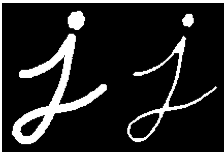
Figura 3-14: Erosión de imagen binaria (OpenCV Docs, 2024)
