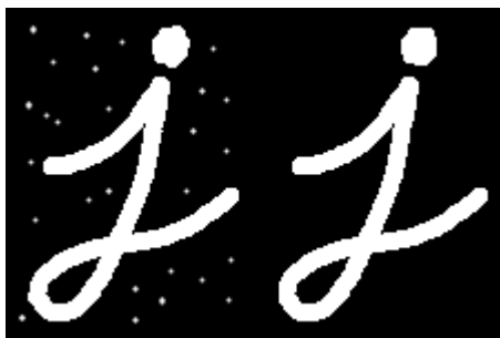
Figura 3-17: Apertura de una imagen binaria (OpenCV Docs, 2024)
