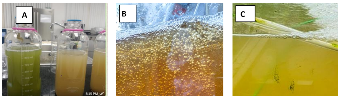
Figura 3.1 Aguas residuales seleccionadas para su tratamiento con microalgas: industria porcina (A), industria cervecera (B) y piscicultura (C).
