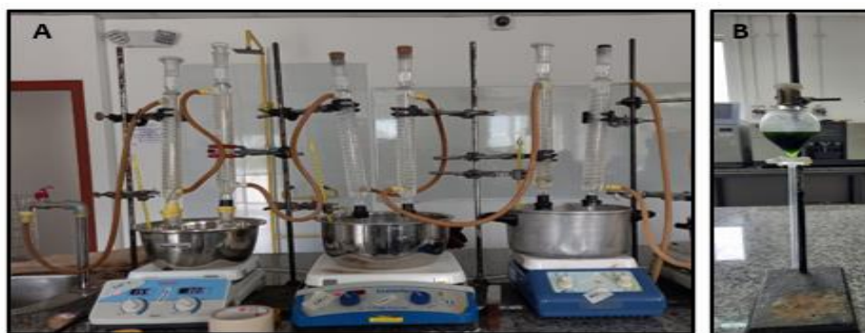
Figura 3.4 A) Equipo de reflujo empleado para la extracción de los ácidos grasos libres. B) Imagen de la etapa de separación bifásica posterior a la extracción de ácidos grasos libres.
