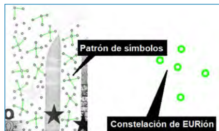
Figura 6. Arriba: marcas en los laterales en relieve reconocibles al tacto y halos de pequeñas dimensiones impresos en los billetes de euro. Abajo: marcas anti-copia: Patrones geométricos incorporados en el papel moneda, para que las impresoras modernas rehúsen realizar su copia al ser detectados
