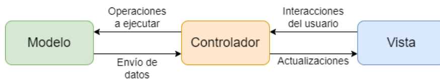
Figura 3.11: Esquema arquitectura Modelo-Vista-Controlador (Imagen de elaboración propia)
