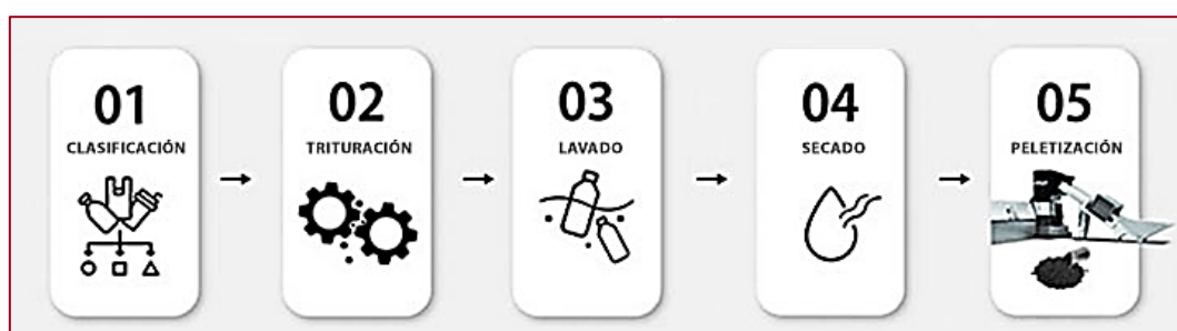
Figura 1.10. Esquema de proceso del reciclado mecánico de residuos plásticos 76 .
