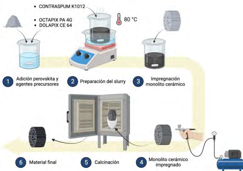
Figura 3.9. Esquema general de los pasos a seguir para el conformado de los materiales sintetizados en polvo en monolitos cerámicos con canales ordenados.
