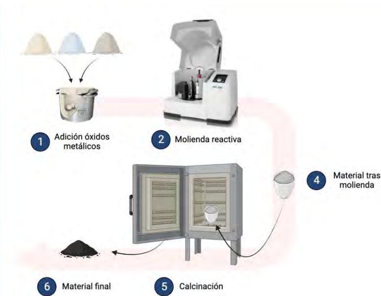
Figura 3.4. Esquema general de los pasos a seguir para la síntesis de los materiales mediante molienda reactiva con un molino de bolas tipo planetario a partir de diferentes óxidos metálicos.
