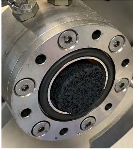
Figura 4.48. Material conformado en estructura cerámica porosa de RPC en el interior del horno tubular de alta temperatura.
