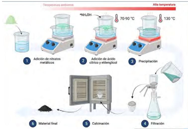
Figura 3.2. Esquema general de los pasos a seguir para la síntesis de las perovskitas sintetizadas por Pechini a diferentes pH (*adición de \text{NH}_4\text{OH} para el caso de la síntesis a pH básico) a partir de diferentes nitratos metálicos.
