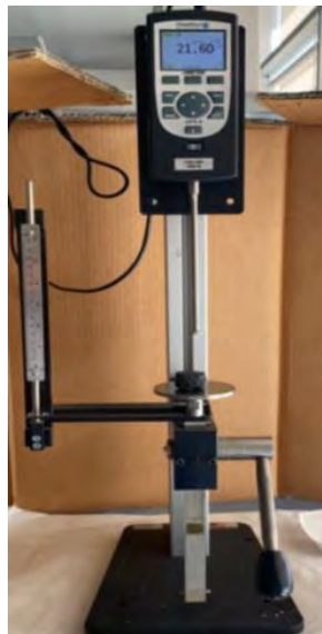
Figura 3.10. Equipo de análisis de resistencia mecánica por compresión (dinamómetro digital).
