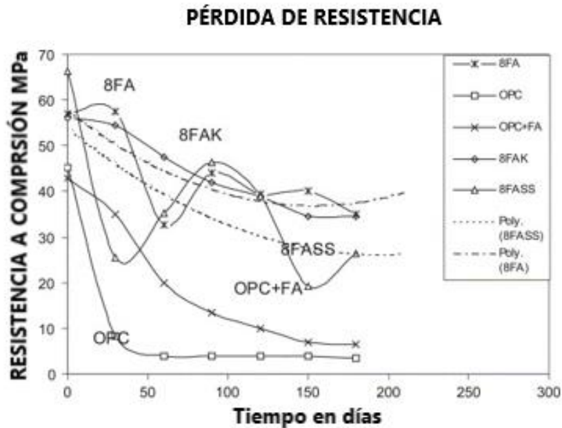
Figura 8 Pérdida de resistencia en presencia de disolución de H 2 SO 4 al 5%
