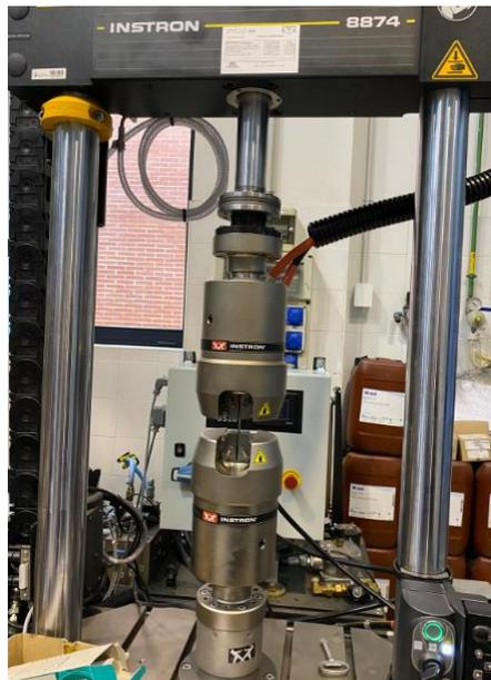
Figura 3.10. Equipo de fatiga Instron 8874.
