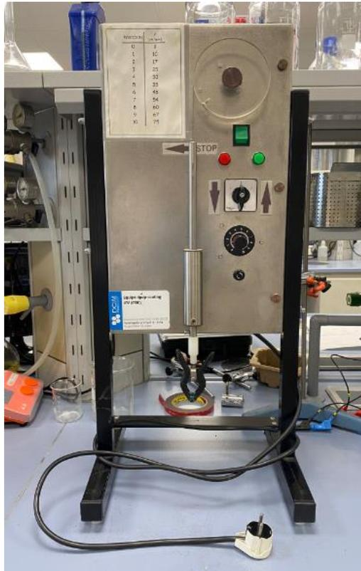
Figura 3.4. Equipo de recubrimiento por dip-coating.
