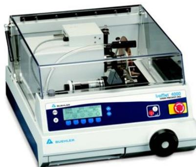
*Figura 3.1. Microcortadora IsoMet 4000.*
