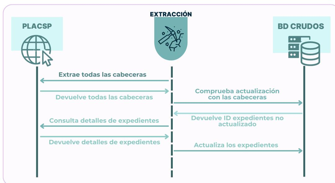
Figura 4.8: Flujo del módulo de extracción de datos.
