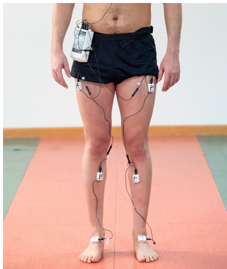
Figura 2.5: Colocación de los IMUs.
