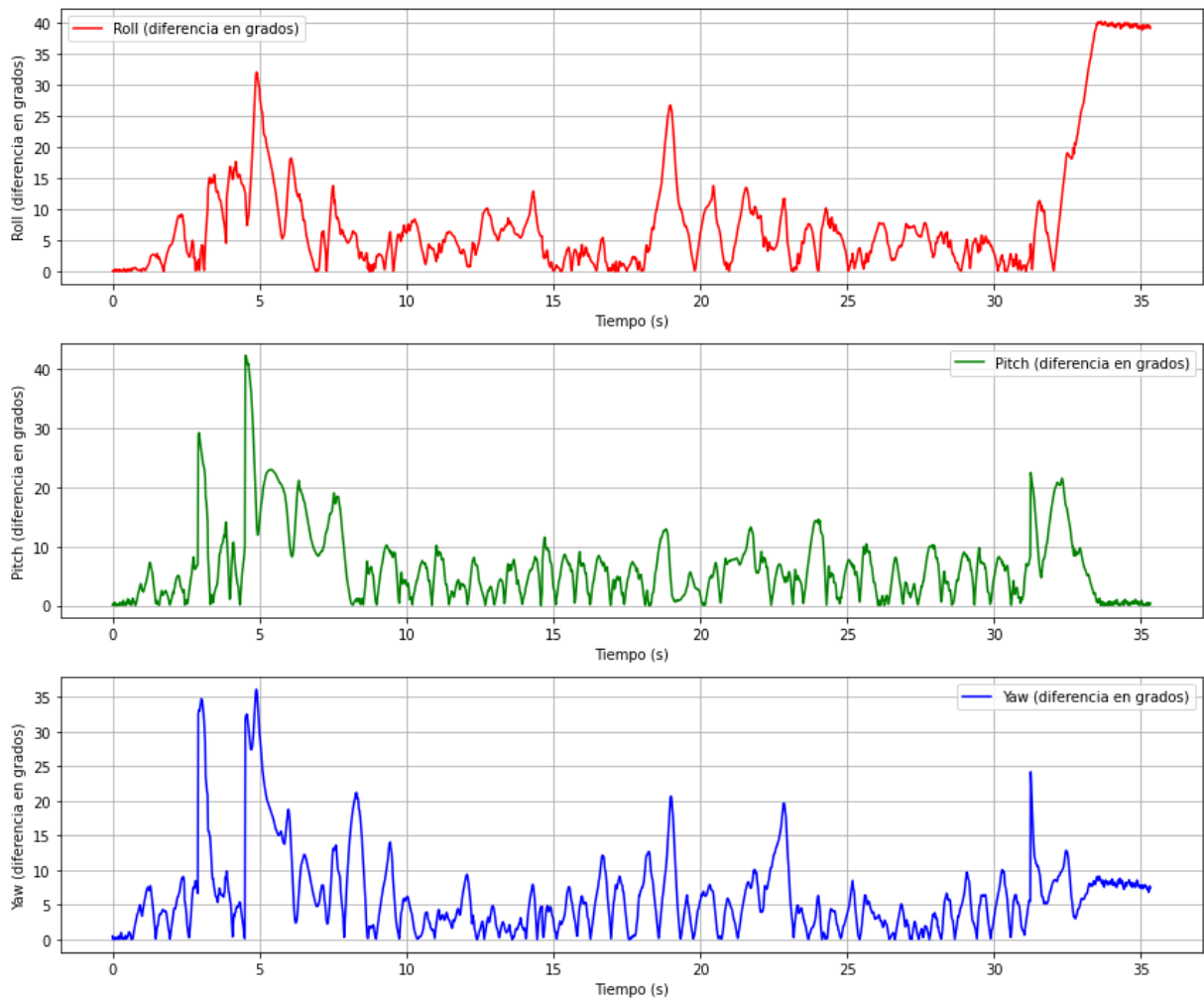
Figura 42: Diferencia de los ángulos de Euler en grados. Captura de IMU en el muslo derecho de muestra de marcha.
