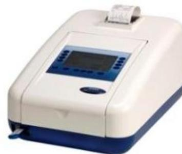
Figura 9. Jenway Espectrofotómetro de haz único UV/Visible modelo 7315.
