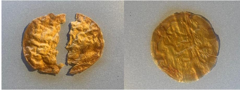
Fig. 3: *Biofilms* de Kombucha. El de la izquierda presentó roturas al doblarse, mientras que el de la derecha, no presentó ninguna fisura tras doblarse.
