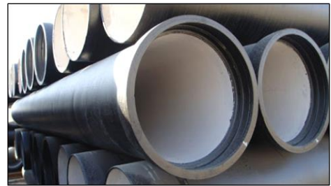
Ilustración 11. Tuberías de fundición dúctil.
