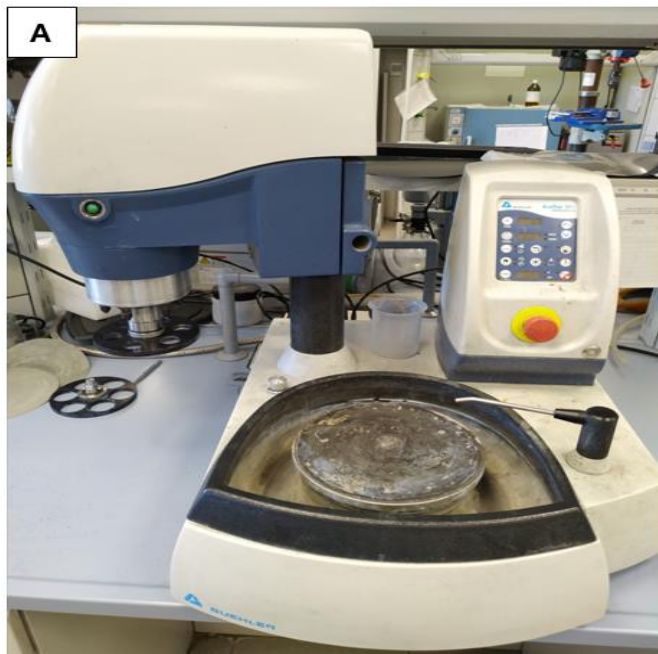
Ilustración 34.A) Pulidora Buehler EcoMet 250. B) Probeta pulida para análisis metalográfico.
