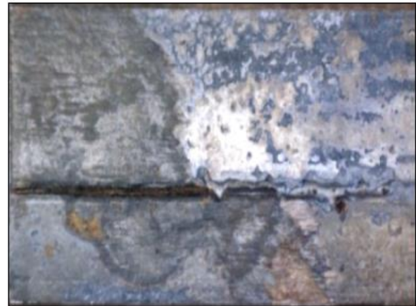
Ilustración 24. A) Tubérculos formados principalmente de Fe_2O_3 en el interior de una tubería de acero galvanizado de agua caliente tras 5 años en servicio. B) Picaduras bajo los tubérculos producidas en el cordón de soldadura. [30]
