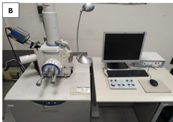
Ilustración 35. Equipos utilizados para la realización de la parte experimental A) Microscopía óptica: Microscopio óptico Leica. B) Microscopía electrónica de barrido: Microscopio electrónico de barrido Hitachi S-3400N.
