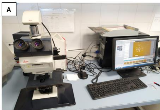
Ilustración 35. Equipos utilizados para la realización de la parte experimental A) Microscopía óptica: Microscopio óptico Leica. B) Microscopía electrónica de barrido: Microscopio electrónico de barrido Hitachi S-3400N.
