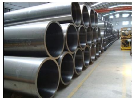
Ilustración 10. Tuberías de acero al carbono.
