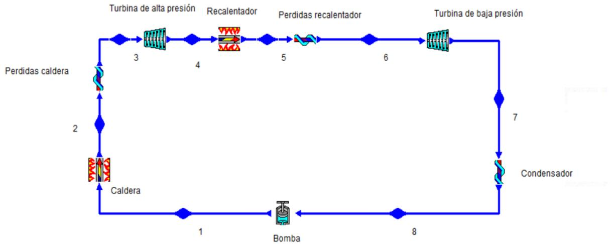
Ilustración 4, Ciclo Rankine con recalentamiento.
