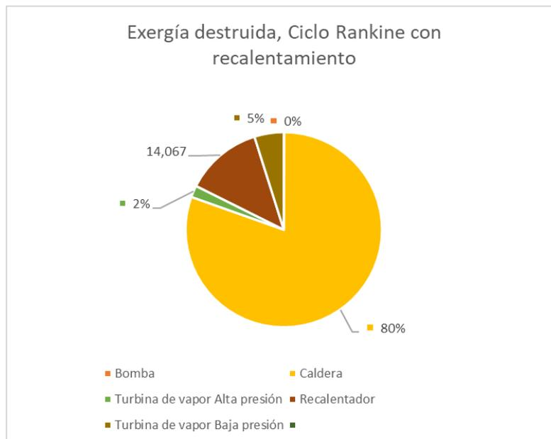
Ilustración 42. Exergía destruida, Ciclo Rankine con recalentamiento.
