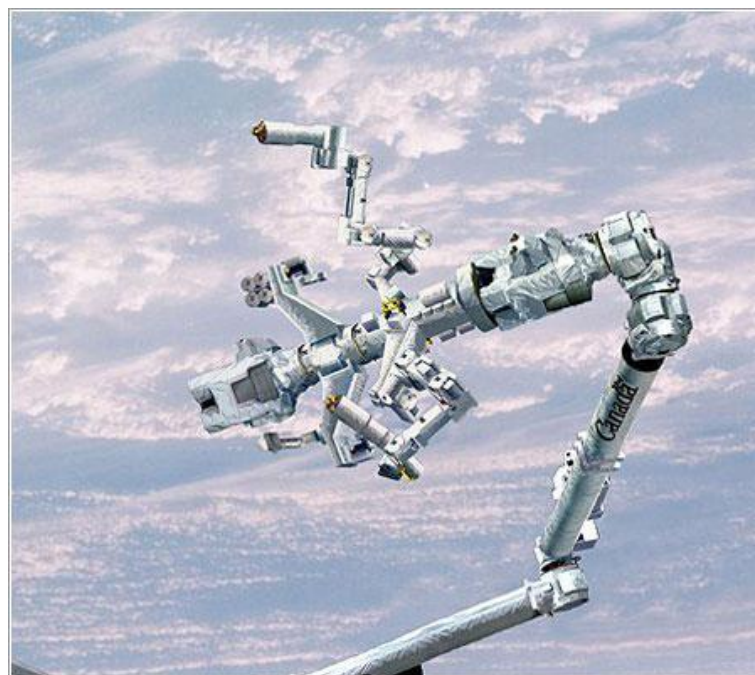
Figura 1.4: Dextre, brazo robótica de la ISS
