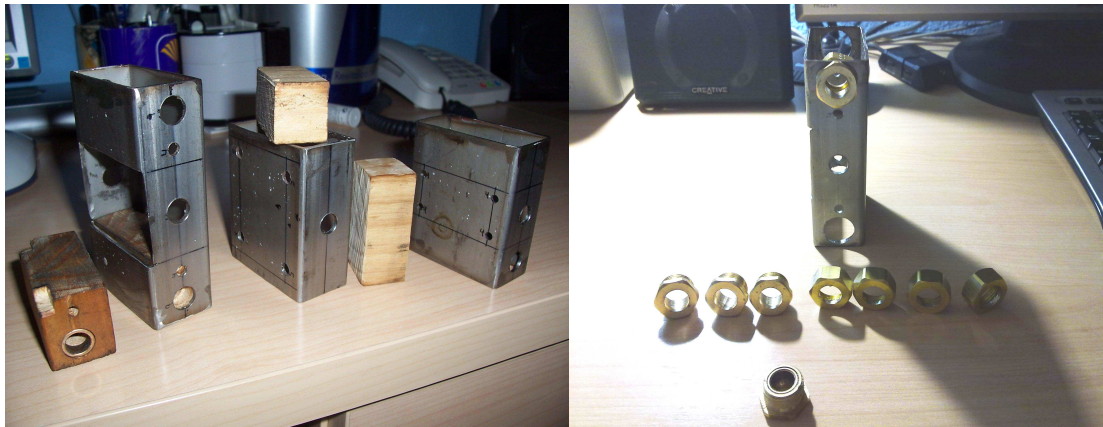
Figura 33: A la izquierda los soportes de madera para los casquillos de cobre de las guías y a la derecha las versiones metálicas en latón
