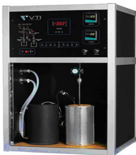
Figura 4.6. Equipo de adsorción volumétrica modelo VTI Scientific Instruments HPVA-100.
