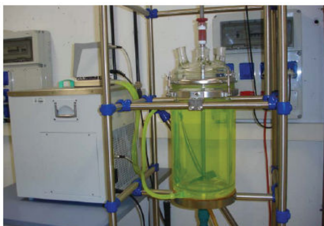
Figura 4.1. Reactor agitado con encamisado externo de etilenglicol para la síntesis del material SBA-15.
