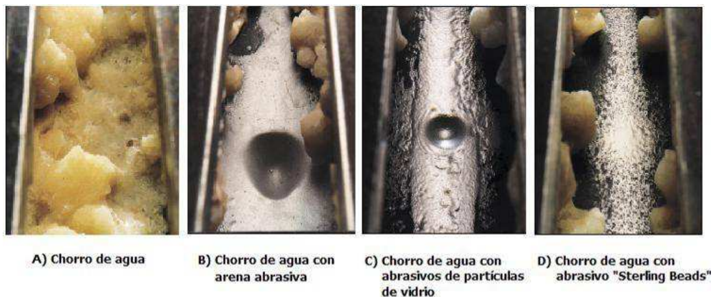
FIGURA 6. Efecto de distintos chorros de agua sobre una tubería con incrustaciones [6]
