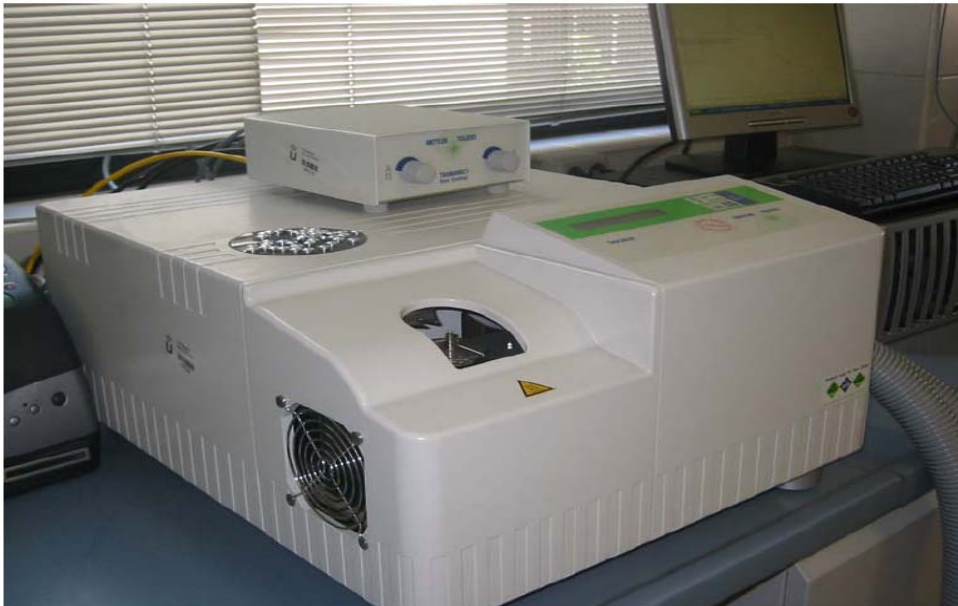
Figura 4.- Calorímetro diferencial de barrido (DSC822e) Mettler Toledo Star System
