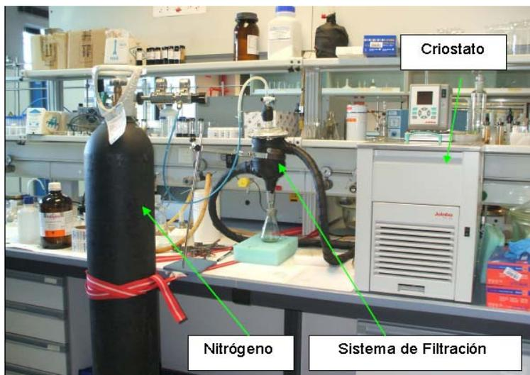
*Figura 4. Instalación experimental de precipitación fraccionada.*
