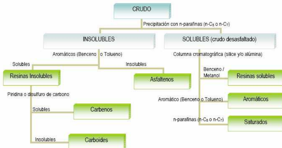
Figura 1: Procedimiento de separación de fracciones pesadas para análisis SARA (saturados, aromáticos, resinas y asfaltenos)
