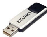
Figura 11. Módulo Bluetooth Ezurio usado en la programación del código.
