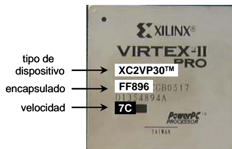
Figura 3.6: Interpretación del texto del encapsulado de la FPGA de la XUPV2P
