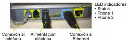
Figura 22.3.: Conexiones del ATA (*Analog Telephone Adaptor*).
