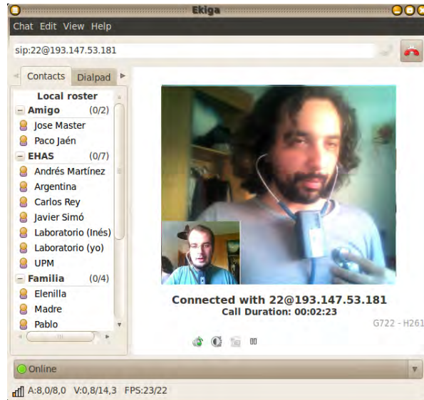
Figura 17.2.: Funcionamiento de Ekiga con G.722 y aplicación de teleestetoscopia.
