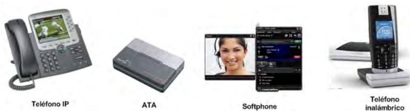
Figura 5.6.: Terminales de telefonía IP.
