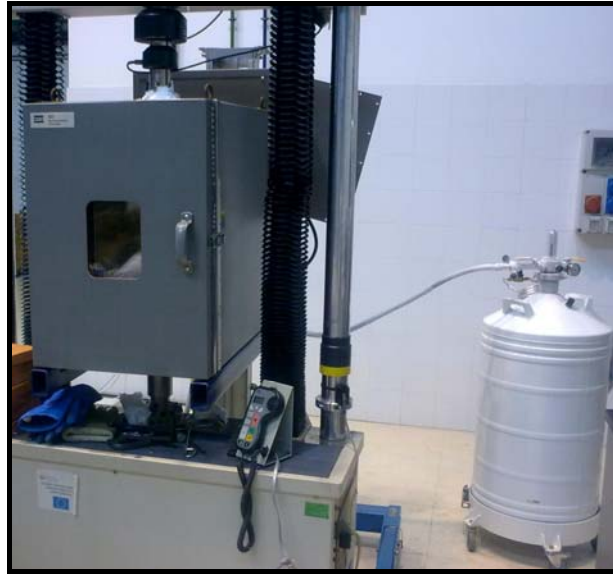
Figura 32. Montaje experimental de los ensayos criogénicos. Cámara climática conectada a un dewar de nitrógeno líquido.
