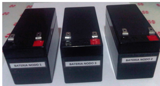
Figura 7.9: Baterías de los nodos sensores
