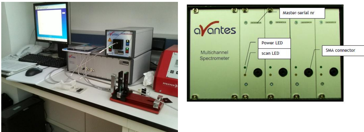
Figura 4.4 - Imagen del espectrofotómetro AvaSpec-USB2, utilizado en las mediciones de las magnitudes ópticas de referencia para el proyecto.
