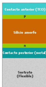
Figura 3.5 - Estructura de una célula de película delgada de silicio amorfo (a-Si). Imagen extraída de la memoria de la tesis doctoral titulada: Prototipo experimental para la medida y caracterización de las curvas I-V y P-V de módulos y Arrays FVs: diseño, modelado, implementación y pruebas.
