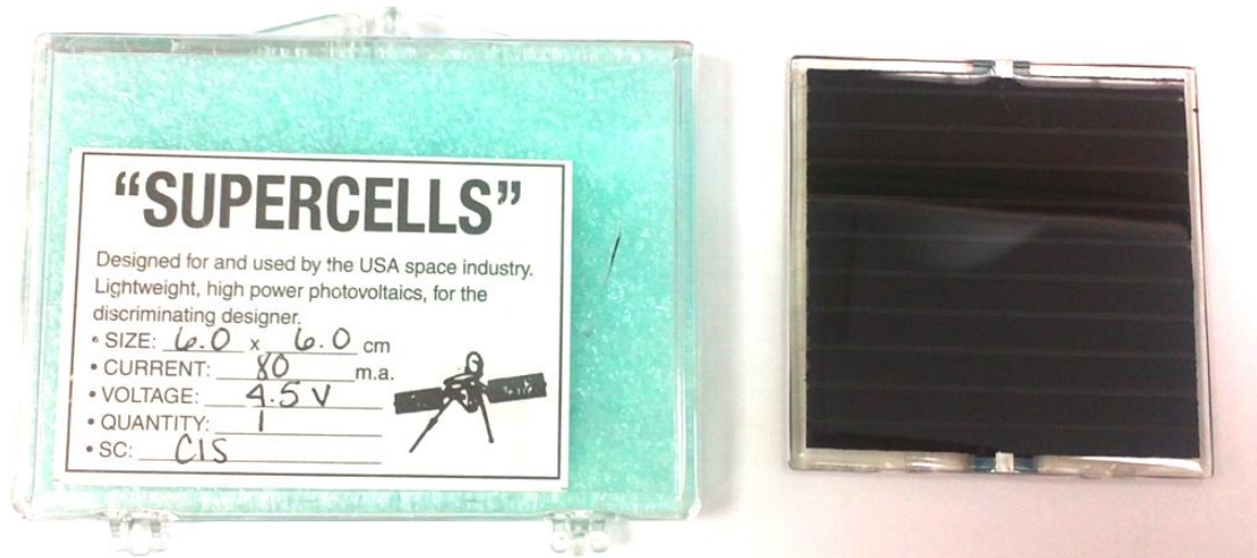
Figura 4.12 - Imagen de una célula comercial fotovoltaica (CIS), utilizada en el proceso de caracterización de este proyecto.
