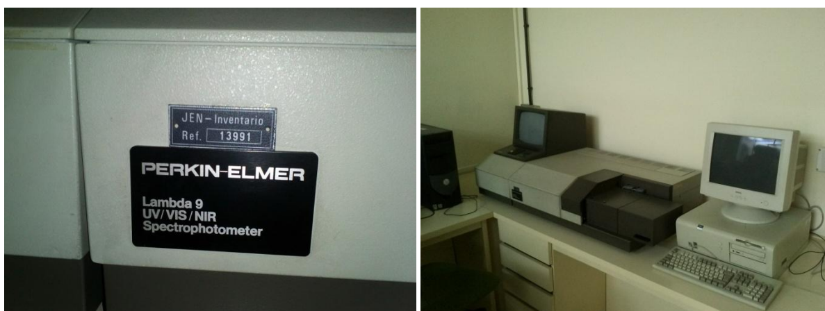
Figura 4.1 - Imagen del espectrofotómetro Perkin Elmer Lambda 9, utilizado en las mediciones de las magnitudes ópticas para el proyecto.
