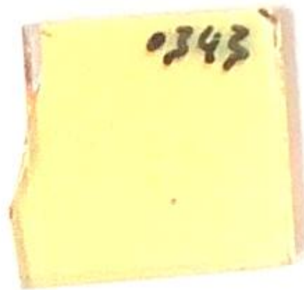
Figura 4.10 - Imagen de una lámina de \text{In}_2\text{S}_3 sobre un sustrato de vidrio, Lámina elaborada por el laboratorio de fotovoltaica del CIEMAT, utilizada en el proceso de caracterización de este proyecto.
