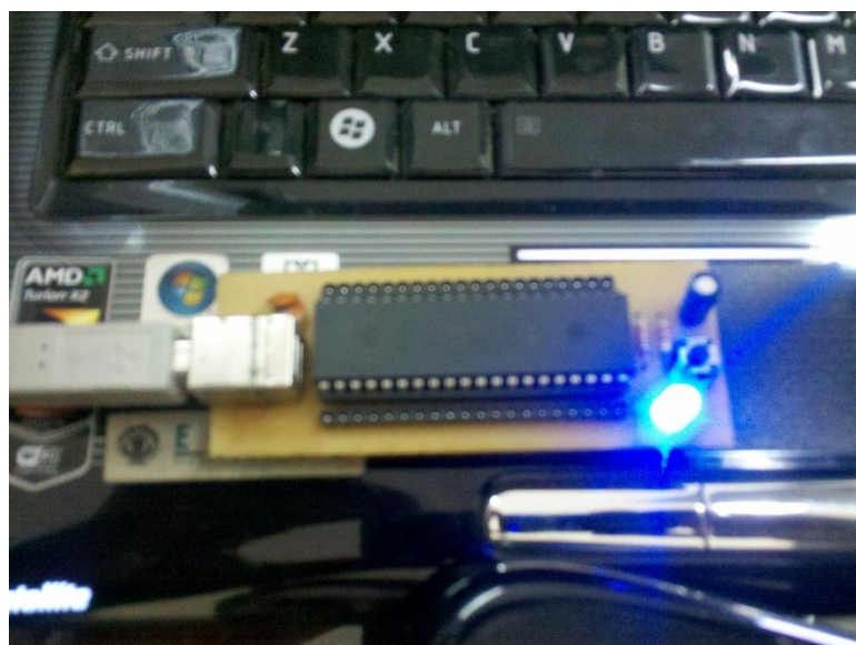
3.1.4 Prototipo tarjeta de adquisición de datos con comunicación
