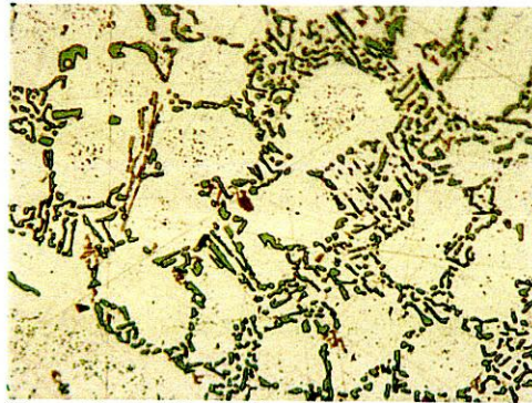
Figura 18. Aleación A361 atacada con ácido. 200 X
