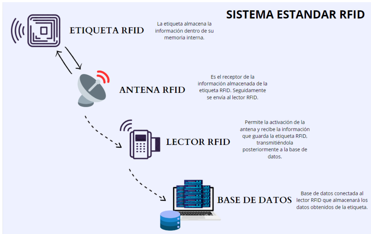
Ilustración 1: Elaboración propia. Sistema Estándar de un RFID
