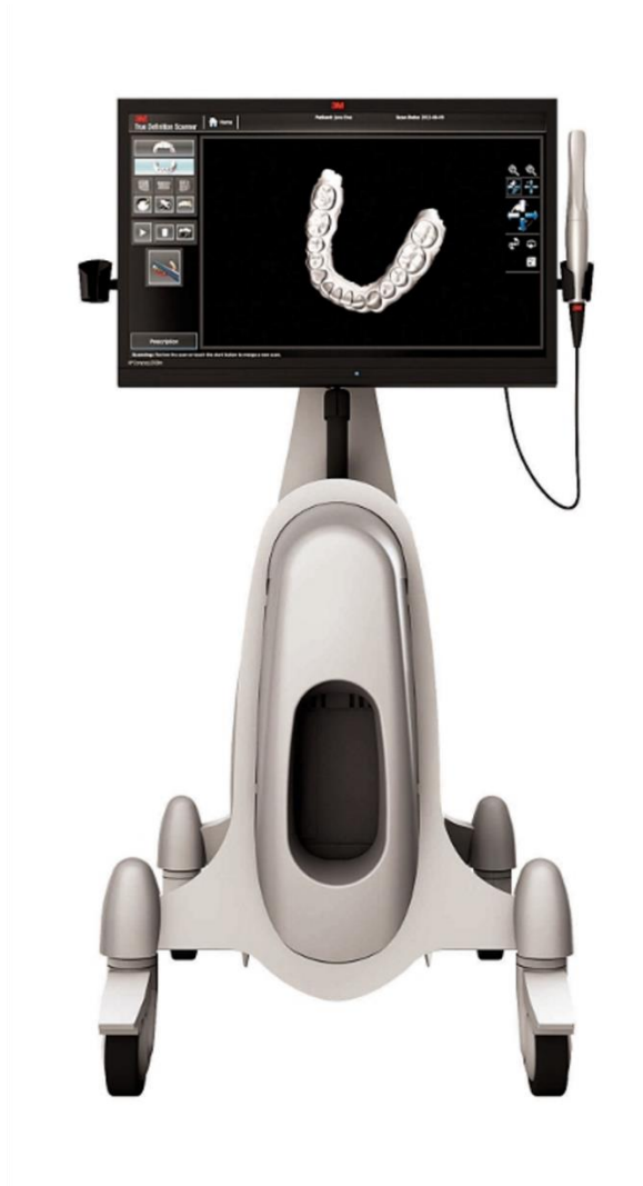
Figura 4.8 Escáner intraoral True Definition, con monitor táctil y varilla de peso ligero. Imagen tomada de Kravitz, Graham, y Redmond 2014.
