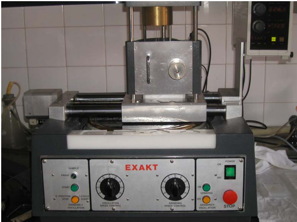
Fig 13 . Sistema de pulido para tejidos duros EXAKT
