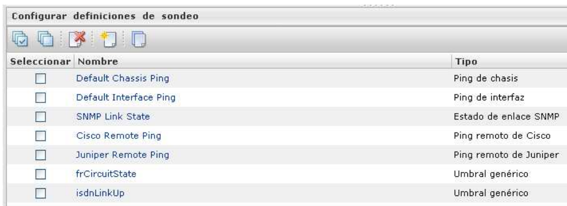
Figura 25. Pantalla que nos permite ver las definiciones de sondeo creadas, a la vez que permite crear una nueva definición.
