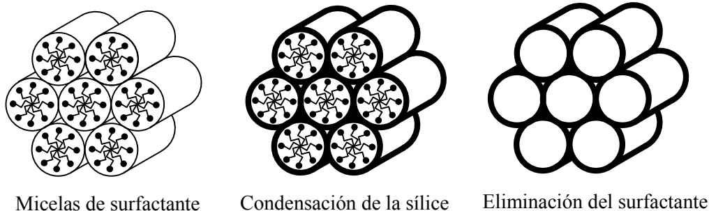
Figura 2.2: Esquema de la síntesis de materiales mesoestructurados.
