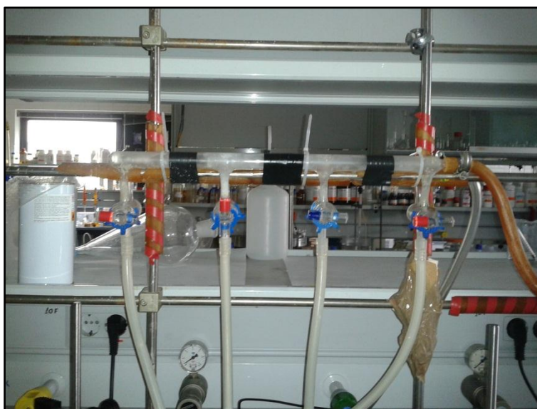
Figura 6. Línea de vacío
