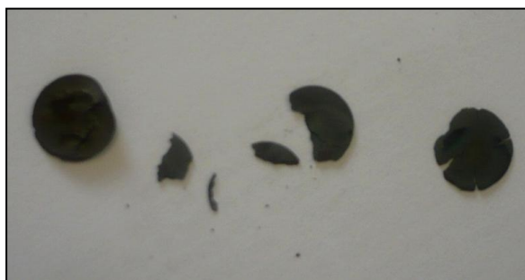
Figura 10. Imagen de las pastillas de ferrita tras ser calcinadas a 1450 °C.
