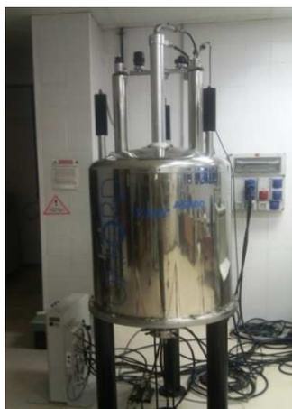
Figura 5.2. Espectrómetro Varian Mercury FT-400
