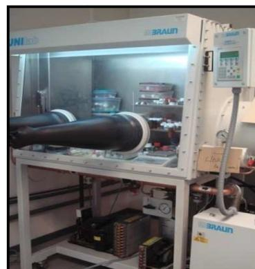
Figura 5.1. Línea de vacío y Caja seca (Mbraum MB-OX-SE1)
