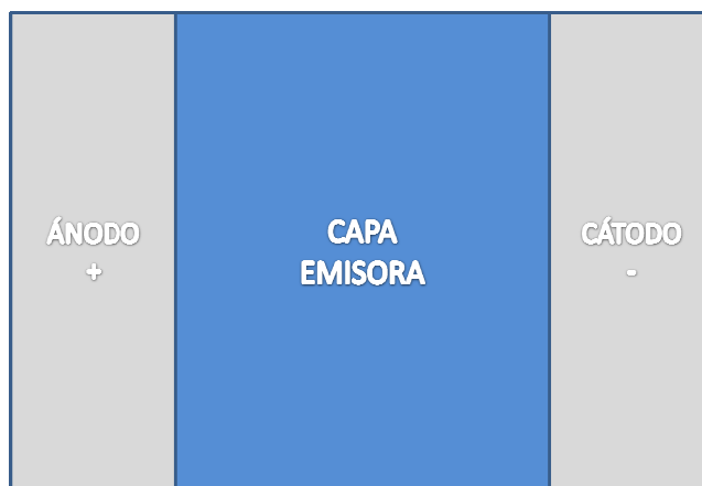
Figura 1.8 Estructura física básica de un OLED
