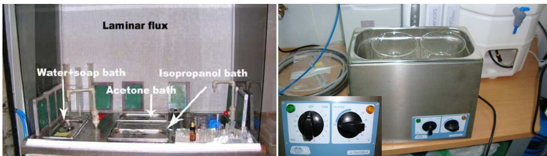
Figura 3.1 Vista general del módulo de limpieza por ultrasonidos (izquierda) y cubeta con cuadro de control ampliado (derecha)
