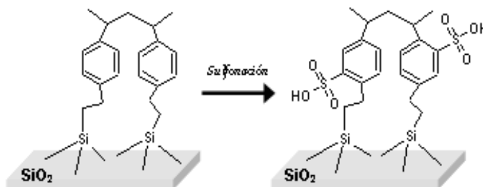
Figura 11. Esquema de sulfonación de los grupos estireno anclados.
