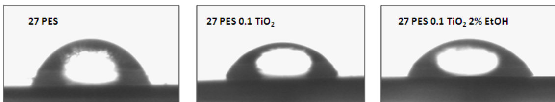
Figura 18: Imágenes de las gotas de agua tomadas en la superficie de diferentes membranas.
