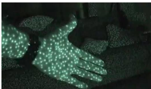
Fig. 2. Imagen de luz estructurada infrarroja captada por Kinect.
