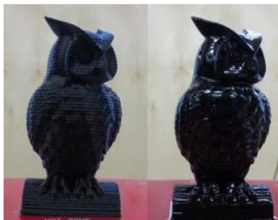
Figura 10. Pieza impresa por FDM antes (izq.) y después (dcha.) del acabado con acetona. [8]
