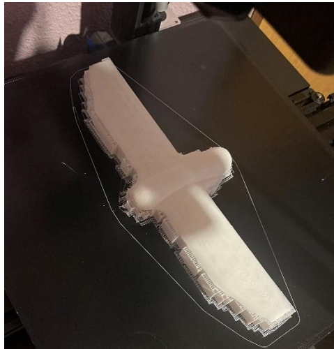
Figura 58. Dron impreso con material de soportes. (fuente propia)
