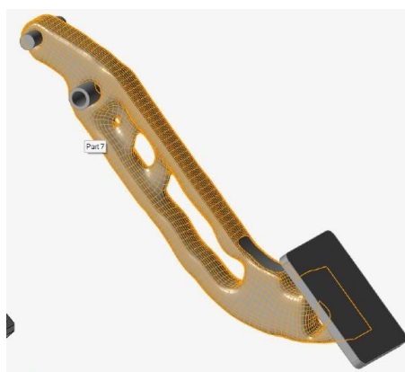
Figura 45. Modelo optimizado con PolyNURBs. (fuente propia)
